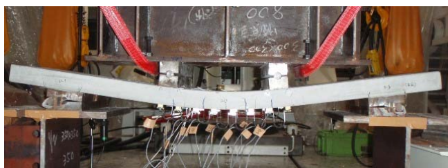
写真-2 試験体の変形状況(载荷終了時)
