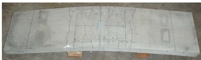
写真-3 試験体底面のひび割れ発生状況
