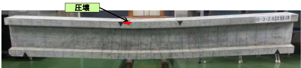
写真-1 破壊状況(B-3-2.8 試験体)
